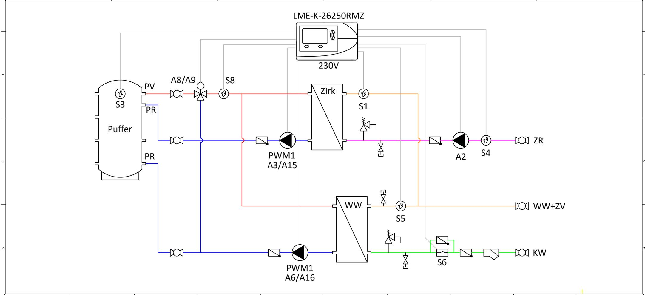
LME | Hydraulikschemata | Frischwassermodul 50-115 Liter mit Zirkulationsmodul 5-10kW
