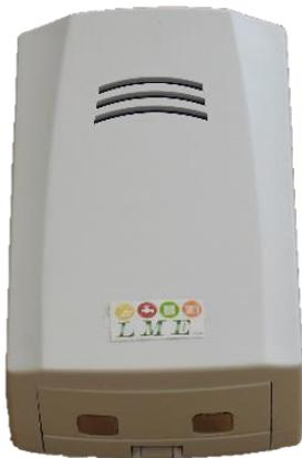
Der Wassermelder ist ein technischer Melder. Er reagiert auf Wasser und andere Flüssigkeiten. Sobald seine Kontaktpunkte (direkt am Melder oder abgesetzt anbringbar; Kabellänge ca. 150 cm) mit Wasser in Berührung kommen, alarmiert er über einen integrierten Signalgeber (85 dB (A) bei 1 m). Der Melder ist einfach am Boden in Wohnungsstation einsetzbar. So können Schäden, die durch Rohrbrüche oder undichte Stellen entstehen, detektiert und durch schnelles Eingreifen verhindert werden.
