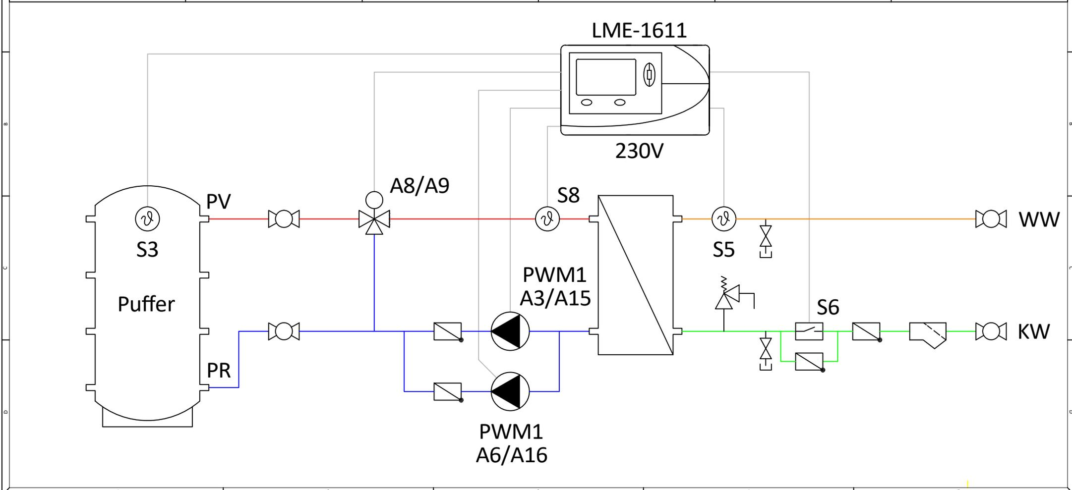
LME | Hydraulikschemata | Frischwassermodul ohne Zirkulation und ohne Rücklaufumschaltung | 150 Liter bis 250 Liter
