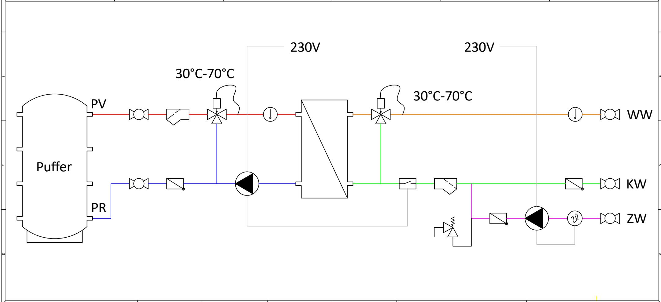
LME | Hydraulikschemata | Einfaches thermisches Frischwassermodul mit Zirkulation | 26 Liter bis 35 Liter
