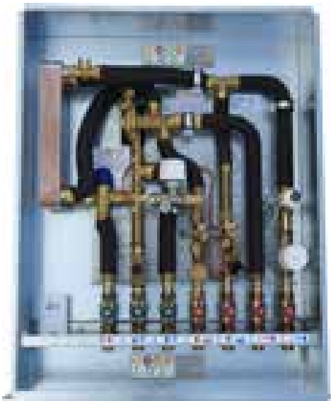
für Radiatorenheizung + Warmwasser mit Kaltwasserdruckminderer 1-4bar mit Brauchwassermischer 35-70°C mit Wassermelder im UP-Kasten Wasserdicht 810x610x150mm
