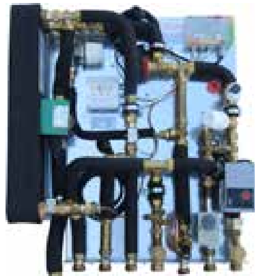
mit elektronischer Regelung für WW 40-70°C mit Festwertregelung für FB-Heizung mit Zirkulationsset samt isoliertem WT mit DDR 0,2-0,6bar primärseitig
