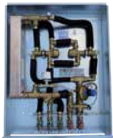
Warmwassermodule mit langem WT und 2x PM-Regler nebeneinander mit Spül-, Füll- + Entleerhähnen primär mit DDR primärseitig im UP-Kasten 810x610x150mm
