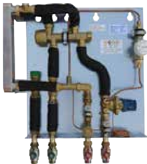
Warmwassermodule mit PM-Regler, mit DDR 0,2-0,6bar mit Brauchwassermischer 35-70°C mit Spül-, Füll- und Entleerhähnen mit Schmutzfilter T-Version auf Grundplatte 590x520x150mm
