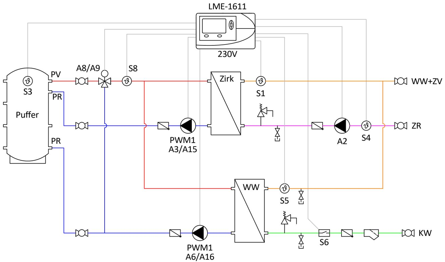
LME | Hydraulikschemata | Frischwassermodul 26-35 Liter mit Zirkulationsmodul 5-10kW
