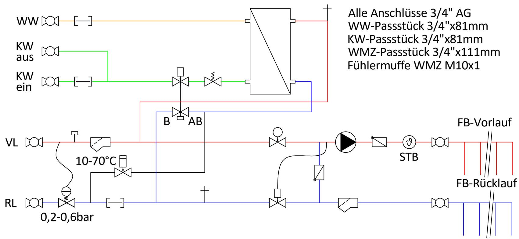
LME | Hydraulikschemata | Wohnungsstation mit Festwertregelung für Fußbodenheizung und FB - Verteiler
