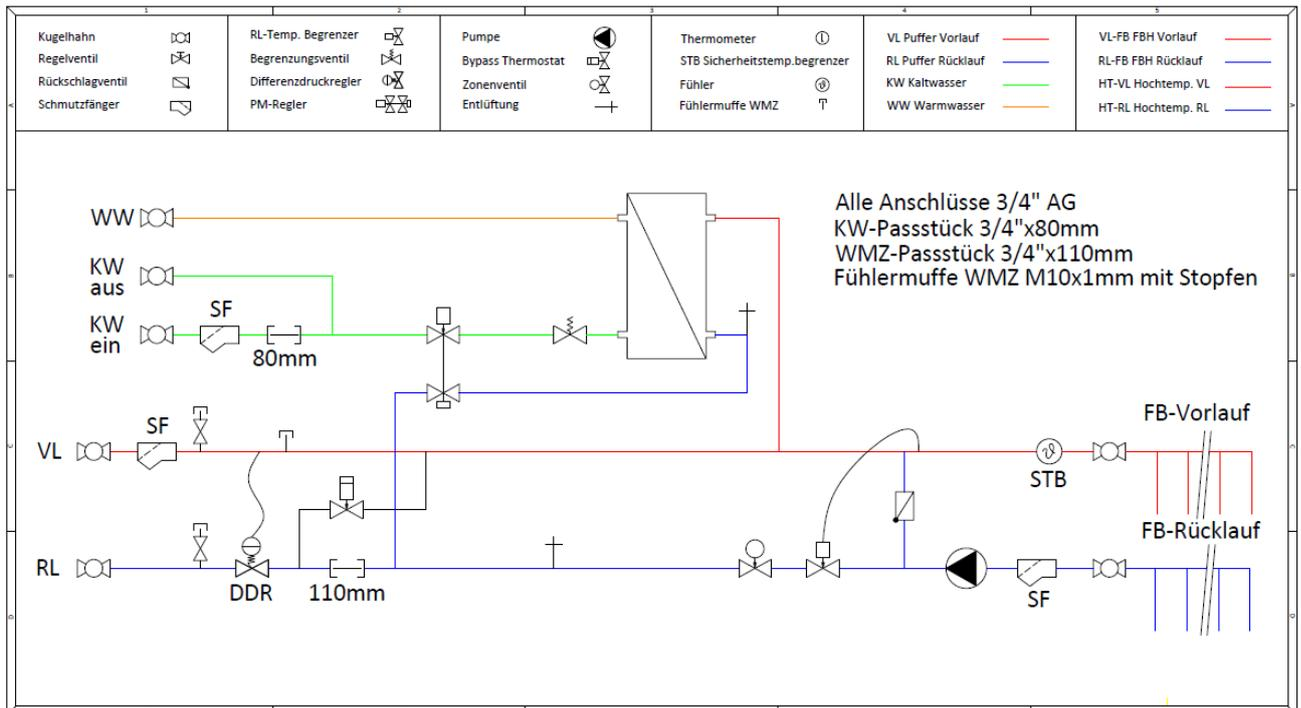
LME | Hydraulikschema | Wohnungsstation Festwert FBH mit PM + Spül + Fußbodenverteiler 2-10 Kreise 36/45/55kW
