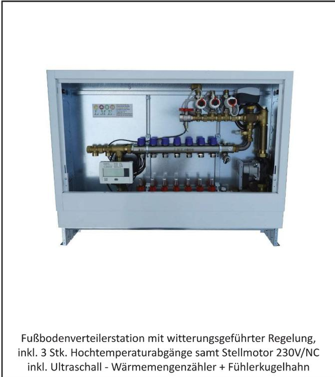
Fußbodenverteilerstation mit witterungsgeführter Regelung,
