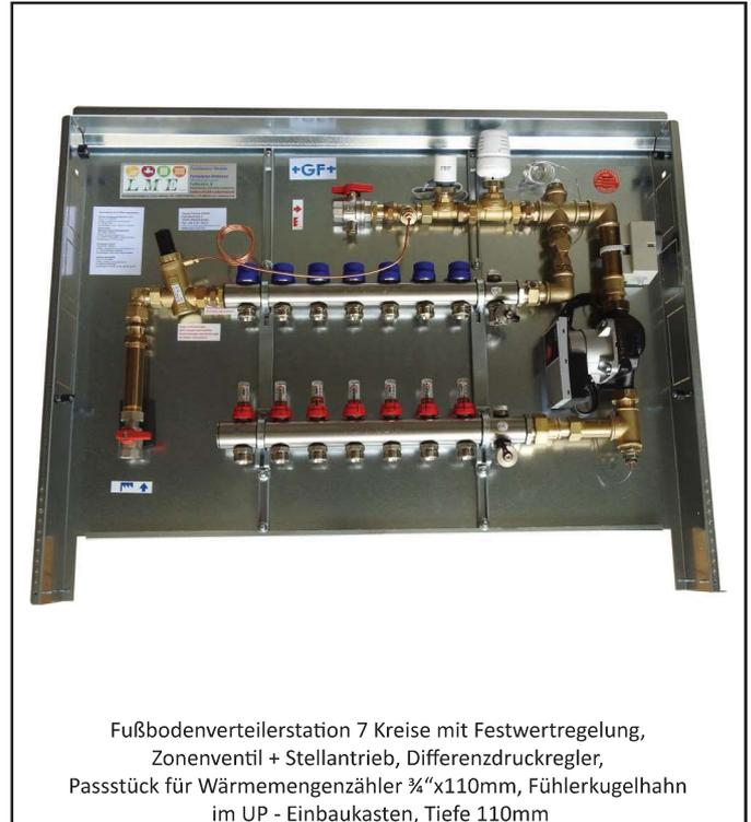
Fußbodenverteilerstation 7 Kreise mit Festwertregelung,
